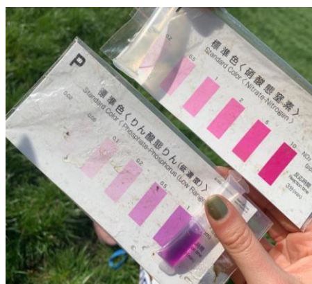
Figuur 2.2.6: De gebruikte sneltesten om de nitraat- en fosfaatconcentratie te bepalen. (Foto: Liselotte Besseling)
