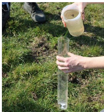
Figuur 2.2.7: De buis met Secchi-schijf om de turbiditeit te bepalen. (Foto: Bo van der Linde)
